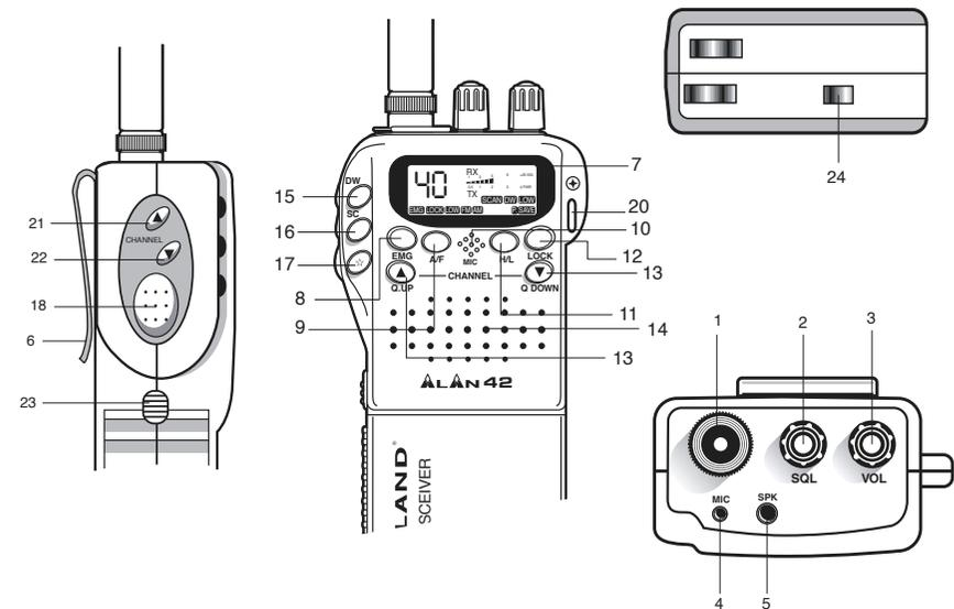
**1. Разъем для антенны** – предназначен для подсоединения антенны, поставляемой в комплекте с радиостанцией. Для улучшения эксплуатационных показателей возможно использование внешней автомобильной антенны.
