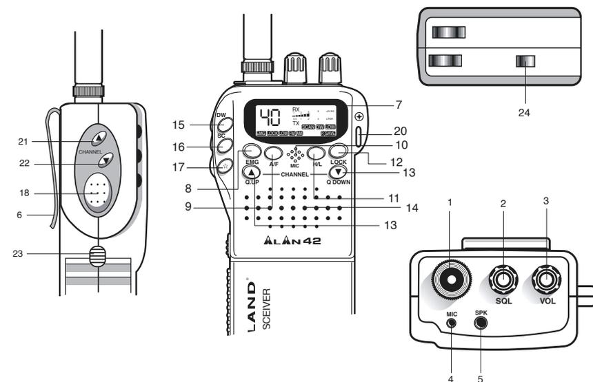
**1. Connettore antenna:** A questa presa va inserita l'antenna in dotazione con l'innesto a baionetta. Per estendere il raggio di copertura, si possono utilizzare antenne esterne veicolari o più efficienti.
