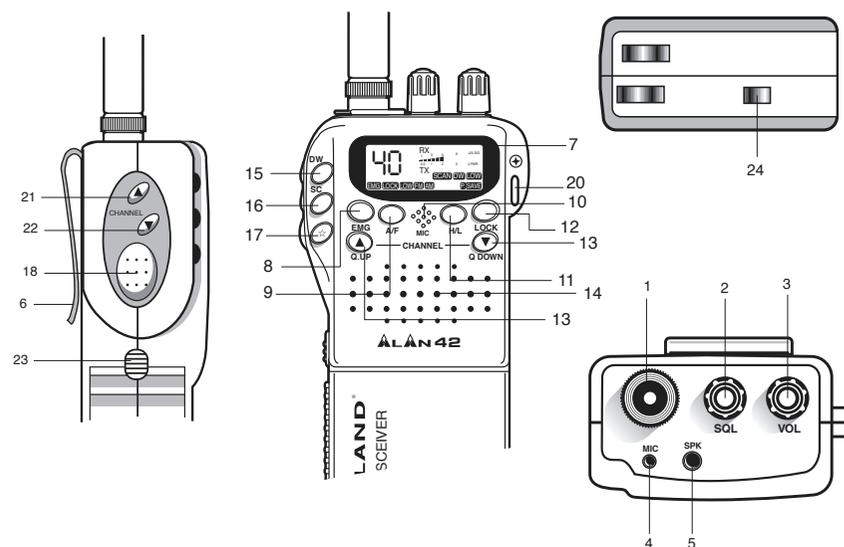
1. **Connecteur d'antenne** : Introduisez dans cette fiche l'antenne livrée avec l'émetteur-récepteur. Pour obtenir les meilleures performances, vous pouvez utiliser une antenne externe montée sur le véhicule.
