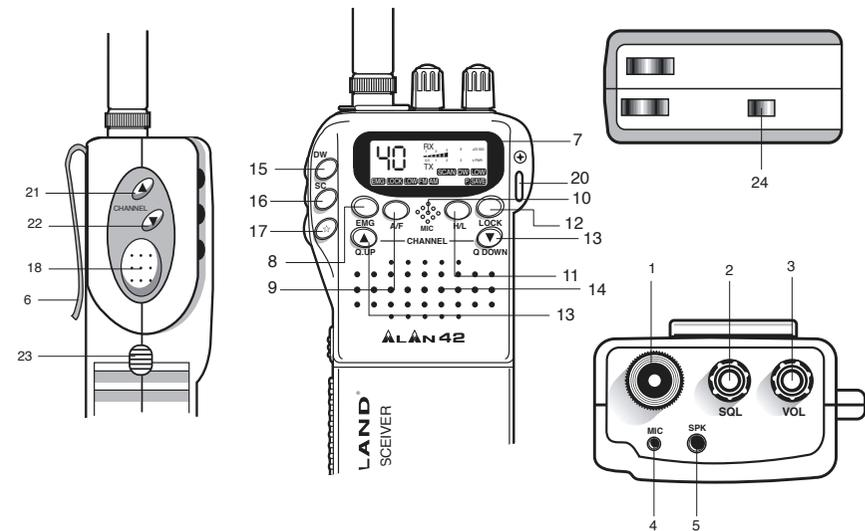
**1. Conector de antena:** con un conector del tipo BNC. Para mejorar sus comunicaciones, utilice una antena telescópica (AT-38) o bien de ganancia (CB-FLEX B).
